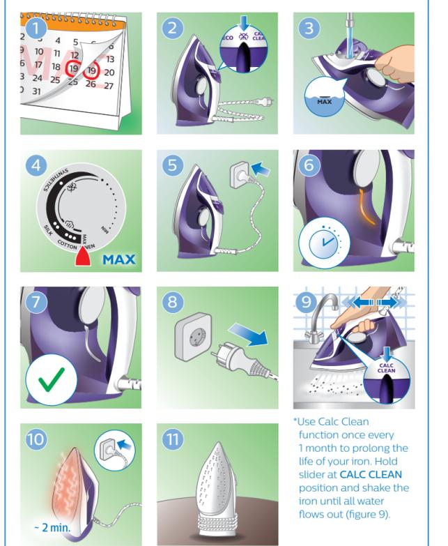
**NL** Gebruik de Calc-Clean-functie elke maand om de levensduur van uw strijkijzer te verlengen. Zet de schuifknop op de Calc-Clean-positie en schud al het water uit het strijkijzer (afbeelding 9).
