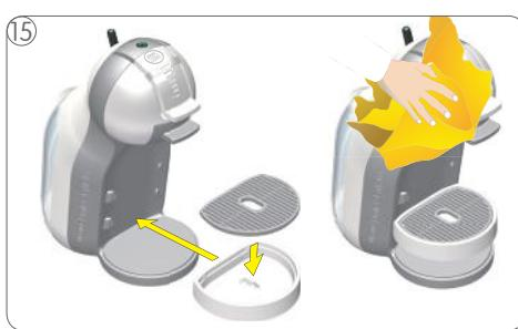
Поместите решетку поддона на поддон. Затем установите поддон на предназначеннное место в машине. Очищайте машину мягкой влажной тканью. После этого высушите ее мягким сухим тканью.
