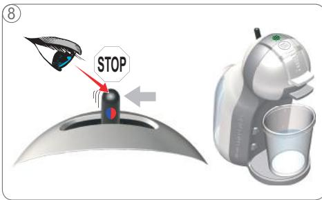
Дождитесь пока рычажок вернется в центральное положение. После того, как цикл очистки от накипи завершен, индикатор кофе-машины мигает зеленым в течение 2 минут.
