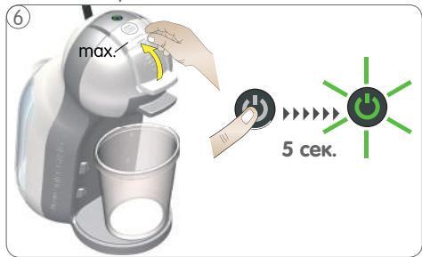
Выберите максимальную дозировку с помощью селектора уровня воды. Нажмите и удерживайте кнопку включения как минимум 5 секунд. Кнопка включения начинает мигать зеленым цветом и машина включает режим удаления накипи.
