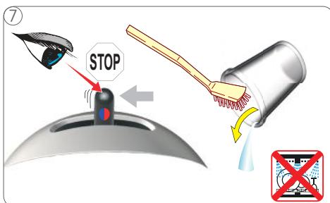
Дождитесь, когда рычажок вернется в центральное положение и подача воды прекратится. Вылейте жидкость из контейнера для воды и промойте его.
