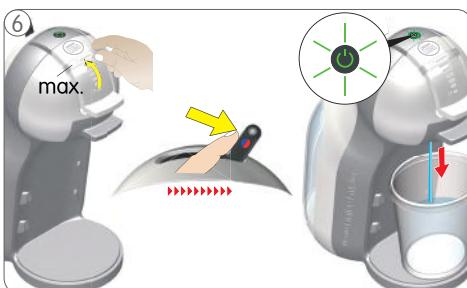
Выберите максимальную дозировку с помощью селектора уровня воды. Передвиньте рычажок вправо, чтобы начать промывку кофе-машины.
