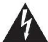
Символ молнии в равнобедренном треугольнике предупреждает пользователя о наличии неизолированного высокого напряжения в устройстве. Это может стать причиной удара током.
