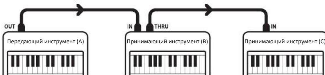
Передающий инструмент (A) использует передающий канал для передачи информации принимающим инструментам (B) и (C). Принимающие инструменты (B) и (C) посылают ответный сигнал инструменту (A), если их принимающий канал соответствует передающему каналу инструмента (A). Если каналы не соответствуют друг другу, то принимающие инструменты не смогут послать ответный сигнал.
