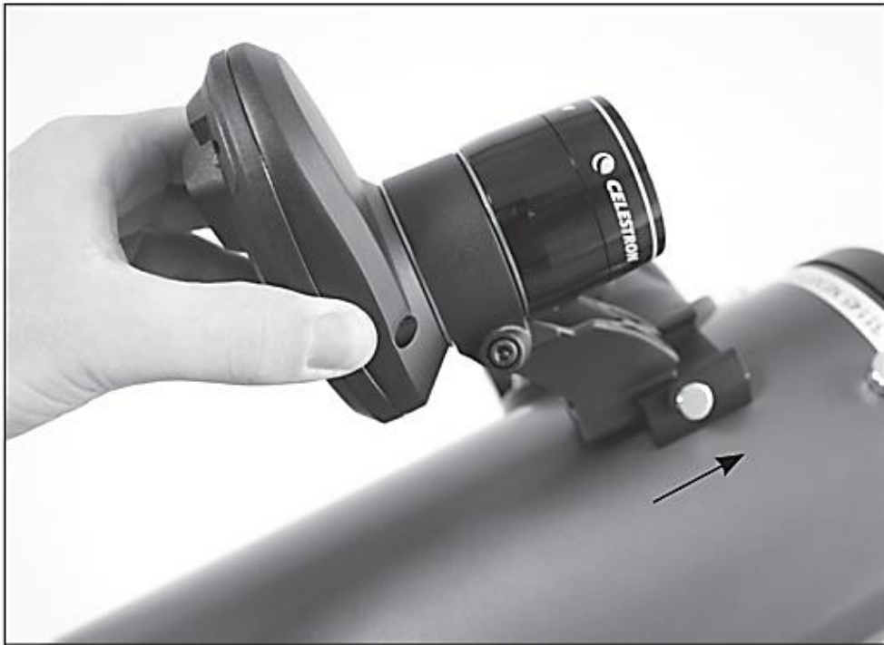
Установка на малую платформу (сзади по направлению вперед)
