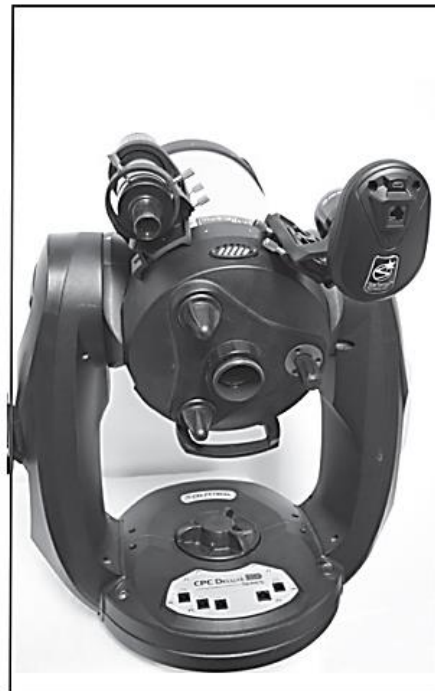
Искатель и камера StarSense, установленные на CPC 800
