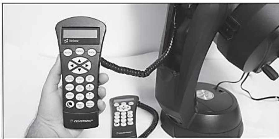
Пульт NexStar заменяется на пульт StarSense
