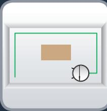
**RU** Для уборки вдоль стен и в углах воспользуйтесь режимом «Вдоль стен». Нажмите три раза на кнопку питания — робот начнет уборку, а кнопка питания будет гореть синим цветом.
