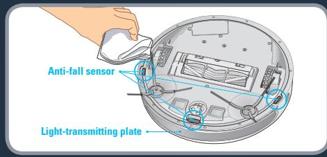
**RU** После каждого применения рекомендуется аккуратно протирать сухой хлопковой тканью прозрачную пластину и датчик во избежание скопления пыли, что может повлиять на работу прибора.
