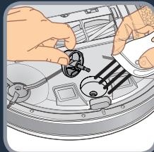
**RU** Очищайте колеса робота один раз в неделю. На вал колеса могут накручиваться волосы, нити. Чтобы извлечь переднее колесо, воспользуйтесь инструментом в комплекте.
