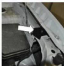
2. Установить кронштейн крыла в отверстие, как показано на рисунке. Плотнo прижать подгиб кронштейна к кузову и затянуть болт М8х20 и гайку М8 с шайбой 8 торцевой головкой №13 с усилием 23 Нм. Установить штатный пластик.
