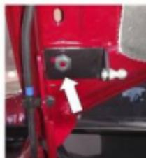
3. Открутить верхнюю гайку крепления капота. Установить кронштейн капота, уперев его в ребро жесткости. Затянуть специальную гайку торцевой головкой №17 с усилием 23Нм.
