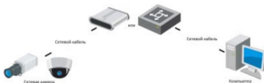
Рисунок 3-2 Подключение через коммутатор или роутер
