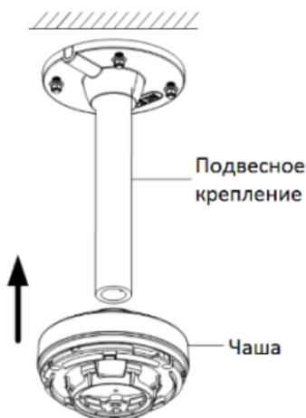
Рисунок 2-41 Установка чаши на подвесное крепление
