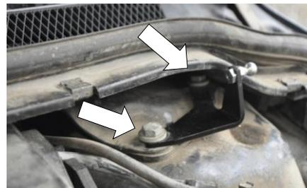
2. Установить кронштейн как показано на рисунке. Затянуть болты ключом №13 с усилием 23 Нм.
