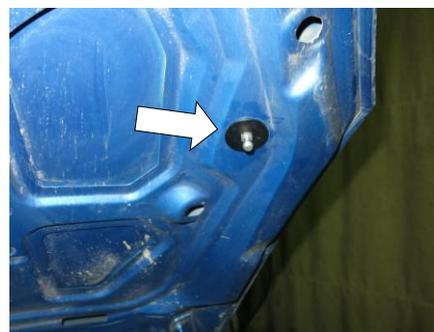
3. Установить болт-шарнир с шайбой и закладной в указанное отверстие. Затянуть болт ключом №10 с усилием 9 Нм.
