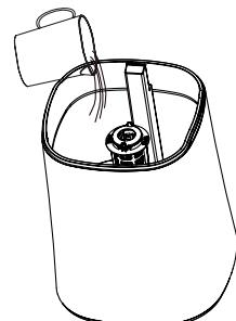
4. Добавьте в резервуар 10–20 капель любого эфирного масла. Закройте крышку резервуара.
