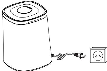
6. Подключите увлажнитель к сети. Прозвучит звуковой сигнал. Индикаторы кнопок загорятся красным цветом, и будет отображаться относительная влажность воздуха в процентах. Последующие пункты можете выполнять как с пульта, так и с панели управления на корпусе увлажнителя.
