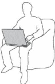
Когда компьютер включен или заряжается аккумулятором, основание компьютера, подставка для рук и некоторые другие части компьютера могут нагреваться. Температура этих частей зависит от интенсивности работы компьютера и уровня зарядки аккумулятора.
