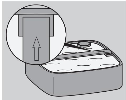
Na górnej krawędzi obudowy filtra, na siatkę przykrywającą i na koszach filtra znajdują się strzałki wskazujące ich prawidłowe ułożenie.
