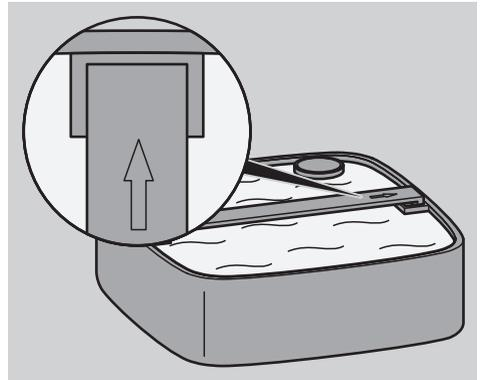
Le bord supérieur du corps du filtre, la grille de protection et les paniers de filtration présentent des flèches qui servent à les aligner correctement.
