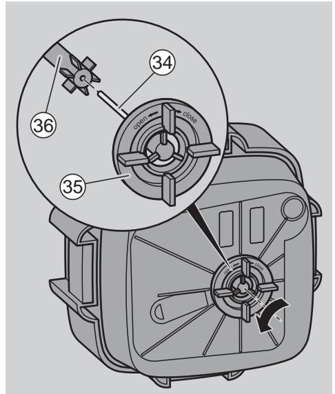
Ротор находится в нижней части головы фильтра.. Ротор состоит из лопастного колеса (36) и керамической оси (34).
