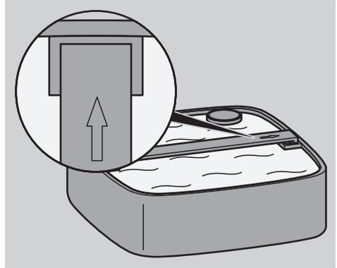
Vid ovankanten av filterbehållaren, vid skyddsgallret och vid filterkorgarna finns pilar som visar rätt håll.
