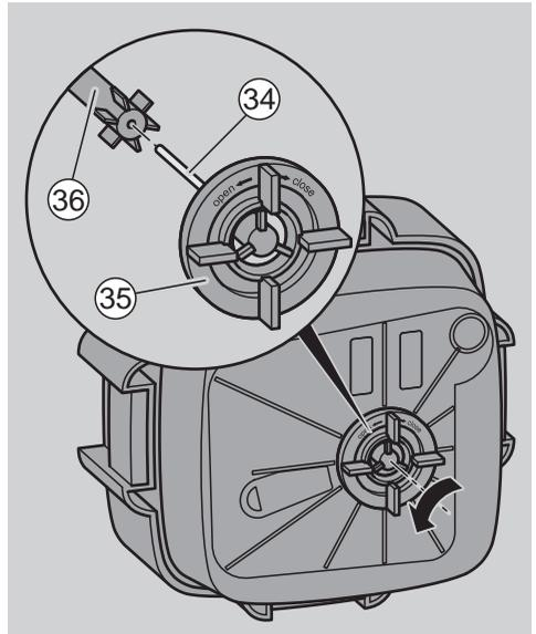
Der Impeller befindet sich auf der Unterseite des Filterkopfs. Der Impeller besteht aus Flügelrad (36) und Impellerschaft (34).
