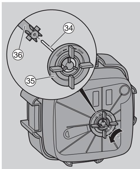
La hélice se encuentra en la parte inferior de la cabeza del filtro. Está formada por un rotor (36) y un eje impulsor (34).
