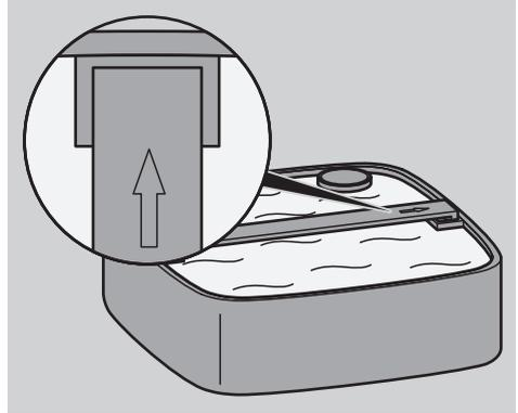
Aan de bovenkant van de filtercontainer, aan het afdekrooster en aan de filtermanden bevinden zich pijlen die helpen bij de correcte uitlijning.
