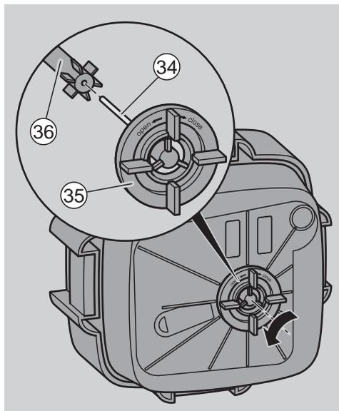
Impellern är monterad på undersidan av filterhuvudet. Denna består av ett fläkthjul (36) och en impelleraxel (34).
