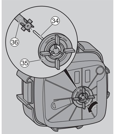
De waaier bevindt zich aan de onderzijde van de filterkop. De waaier bestaat uit een waaier (36) en een waaerschacht (34).
