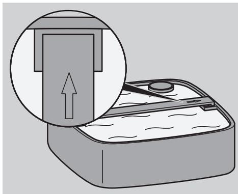
На верхнем краю корпуса фильтра, на защитной решетке и фильтрующих лотках находятся стрелки для правильного выравнивания и установки.
