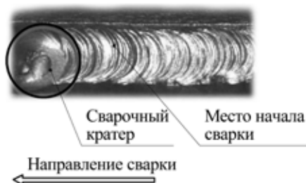
Рис. 7.4. Начало сварки при смене электрода.
